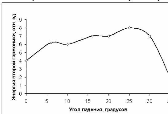
Рис. 16 Зависимость интенсивности второй гармоники от угла поворота кристалла.
