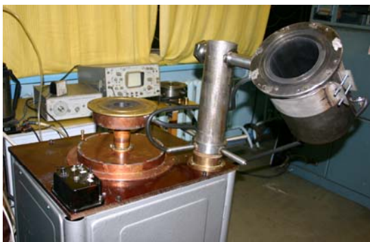
Рис. 14. Фотография установки для ВЧ синтеза наночастиц (фуллеренов, углеродных нанотрубок) в потоке гелия
